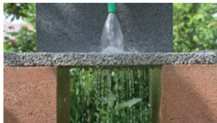
Wasserdruchlässige Platten. Das Verlegen dieser Platten versiegelt den Boden nicht. Quelle: USEPA Environmental-Protection-Agency
