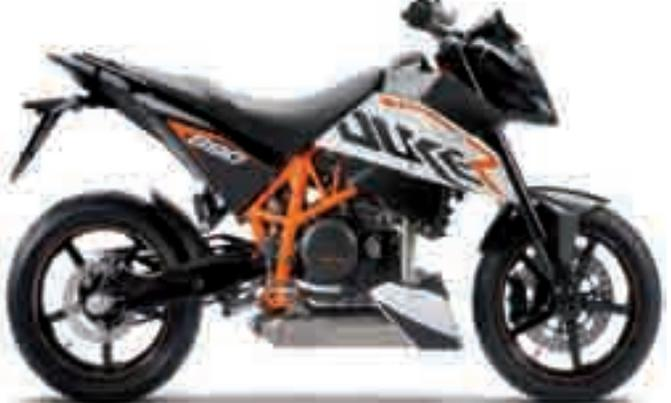
690 cm<sup>3</sup> Hubraum - Einzylinder. Facts: Einzylinder-Viertakt-Motor, Bohrung/Hub 102/84,5 mm, Leistung 70 PS bei 7500/min. Drehmoment 70 Nm bei 5500/min. Preis: ab 9.495,-
